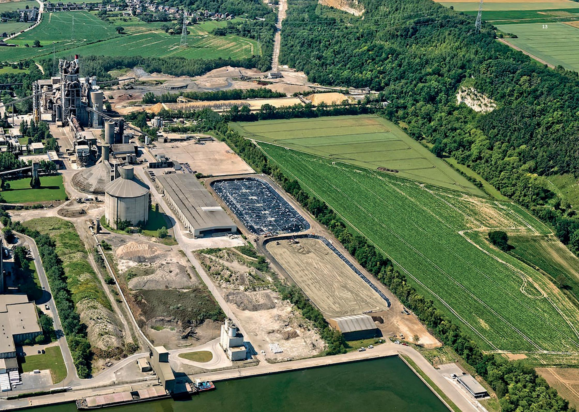
Le site comprend deux carrières de calcaire (Loën et Romont), un four à clinker, les installations de broyage ciment ainsi que les équipements nécessaires aux expéditions en vrac et en sacs des différents ciments fabriqués.
