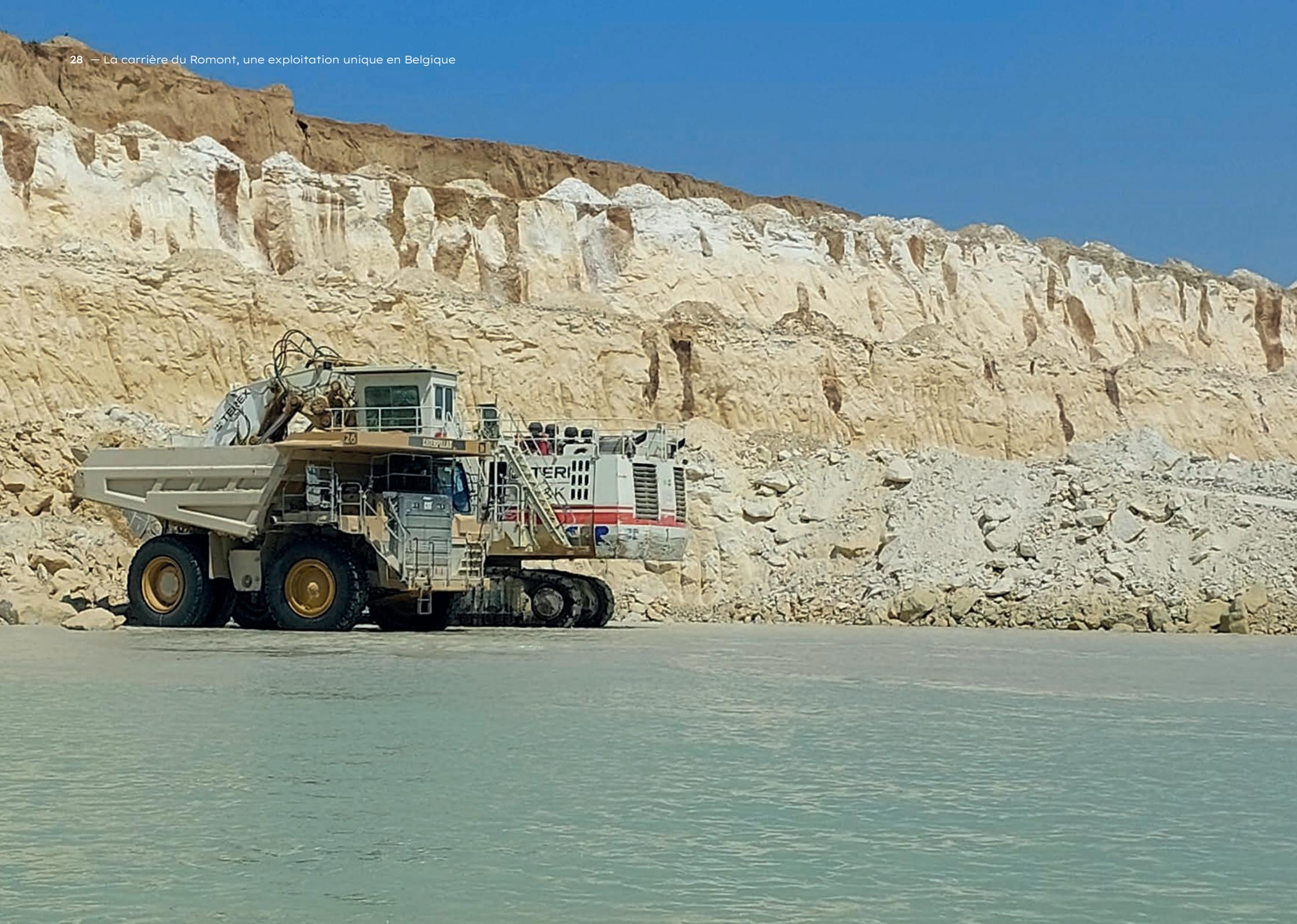
Le front de taille montre que les couches de craie ont une allure tranquille avec un pendage léger (1 à 2 %) vers le nord. Le tuffeau est exploité sur une hauteur d'environ une vingtaine de mètres, tandis que la craie grossière l'est sur une dizaine de mètres jusqu'au niveau de la nappe aquifère (niveau 65-66m d'altitude).
