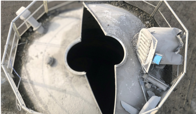
Geëxplodeerd filterhuis door overdruk
