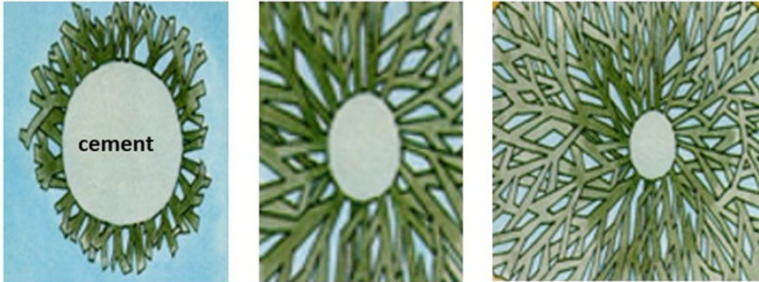
Werking cement als bindmiddel
