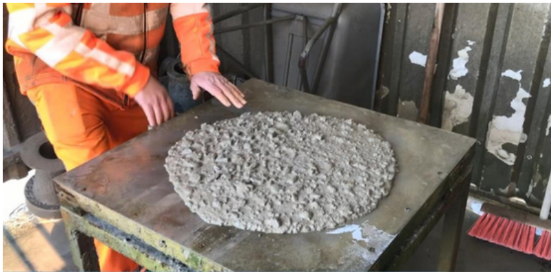
De laborant controleert bij dit mengsel de vloeimaat
