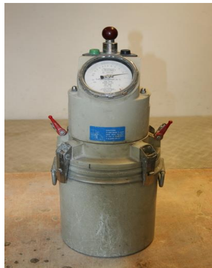
Figuur 3.5 Luchtgehaltemeter voor de bepaling van het luchtgehalte van betonspecie.
