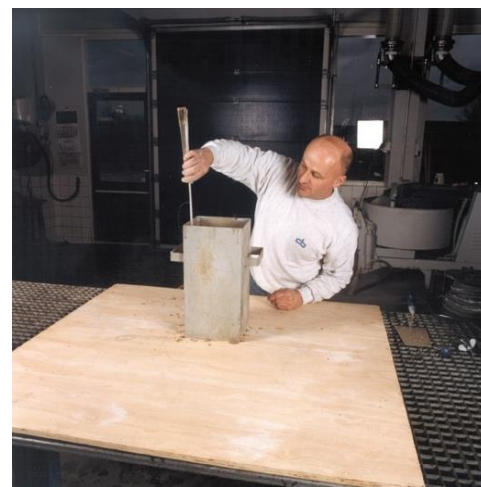
Figuur 3.1 Het meten van de inzakking ten behoeve van het berekenen van de verdichtingsmaat.
