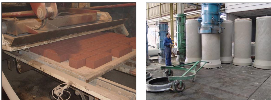
Figuur 4.4 Vervaardiging van betonproducten, gebruikmakend van 'groene sterkte'
