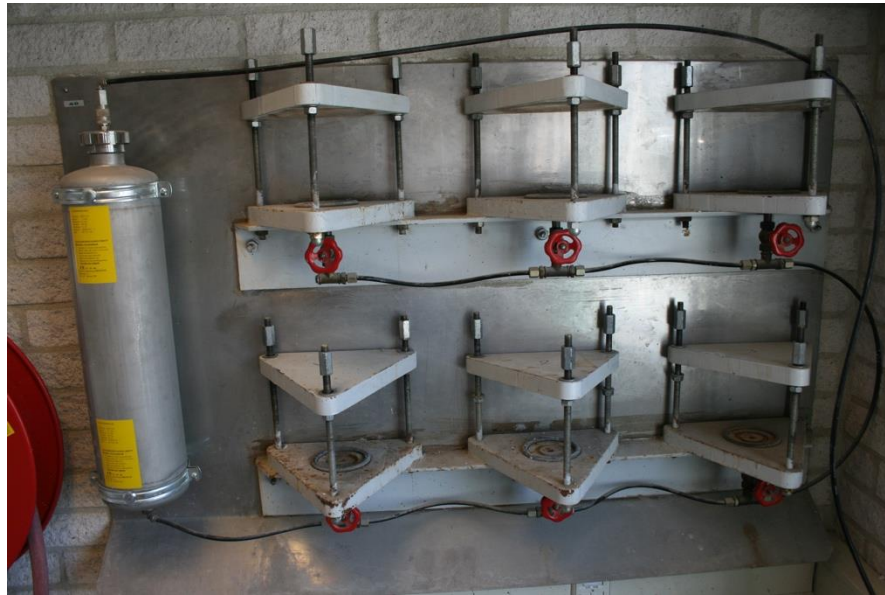
Figuur 3.14 Apparatuur voor de bepaling van de vloeistofdichtheid.
