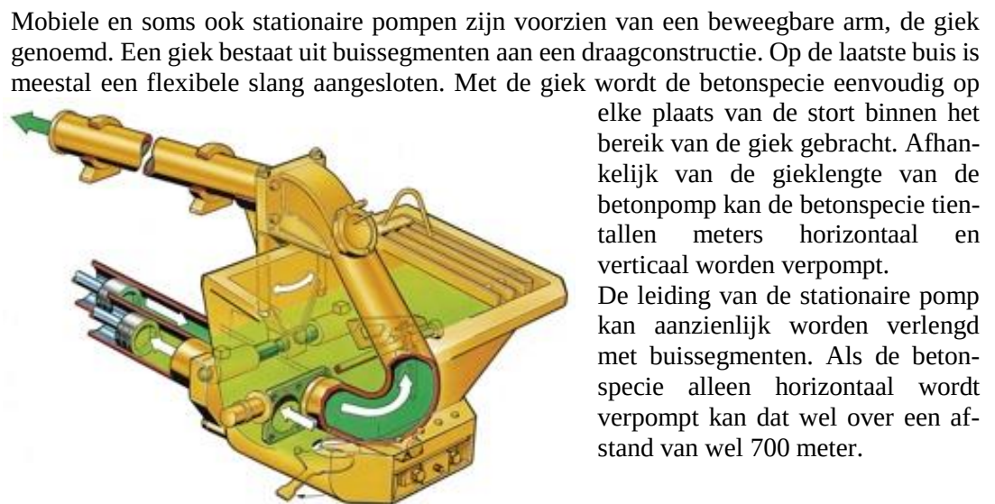
Figuur 7.4 Schematische tekening van betonpomp.
