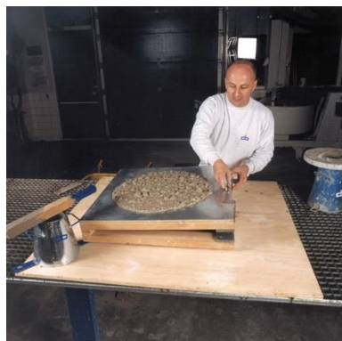
Figuur 3.4 Heffen en laten vallen van bovenblad ter bepaling van schudmaat.
