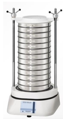
zeefmachine met boven elkaar ge- plaatste zeven
