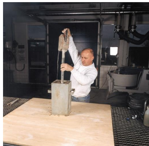
Figuur 3.1 Verdichten betonspecie in vat van Walz
