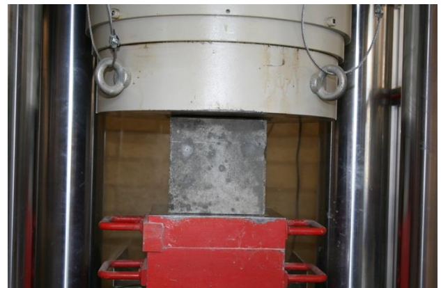
Figuur 3.9 - Druksterkte bepalen in een drukbank
