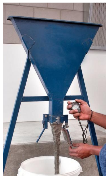
Figuur 3.15 Meting met behulp van de V-trechter
