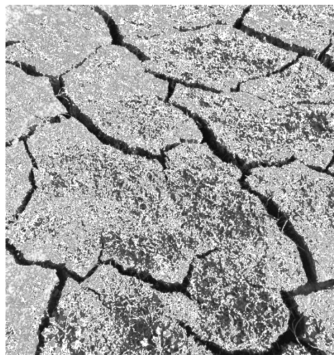
Figuur 3.7 Voorbeeld van plastische krimp-scheuren (in uitgedroogde klei.)
