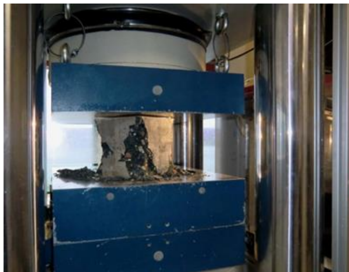
Figuur 3.9 De kubus na het bezwijken.
