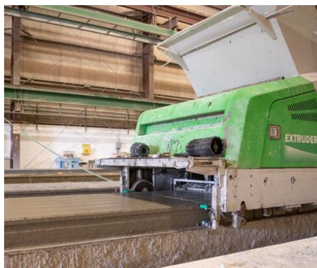
Figuur 7.11 Extrusie-apparaat bij de vervaardiging van kanaalplaten.
