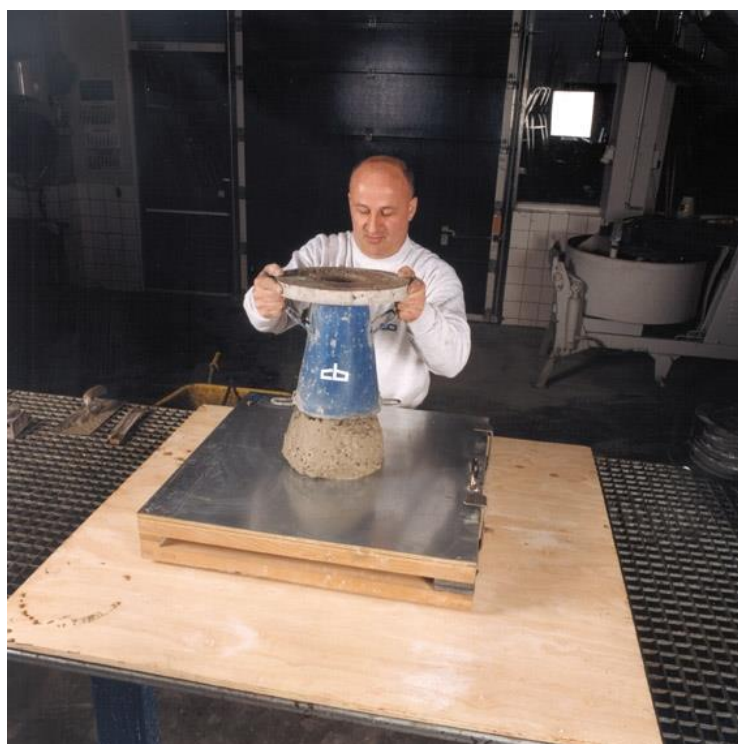
Figuur 3.2 Heffen van de kegel voor het bepalen van de zetmaat.
