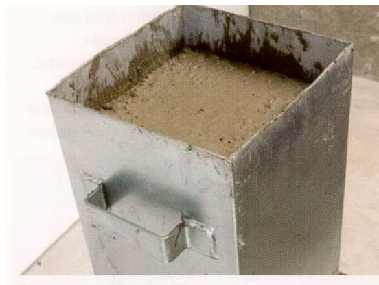
Figuur 3.1 Het meten van de inzakking ten behoeve van het berekenen van de verdichtingsmaat.
