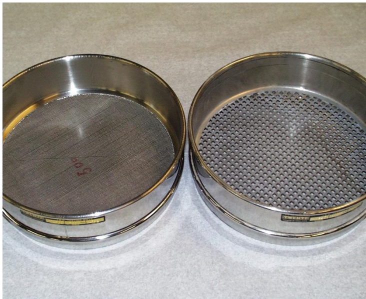
Figuur 2.9 Draadzeef (links) en plaatzeef (rechts).
