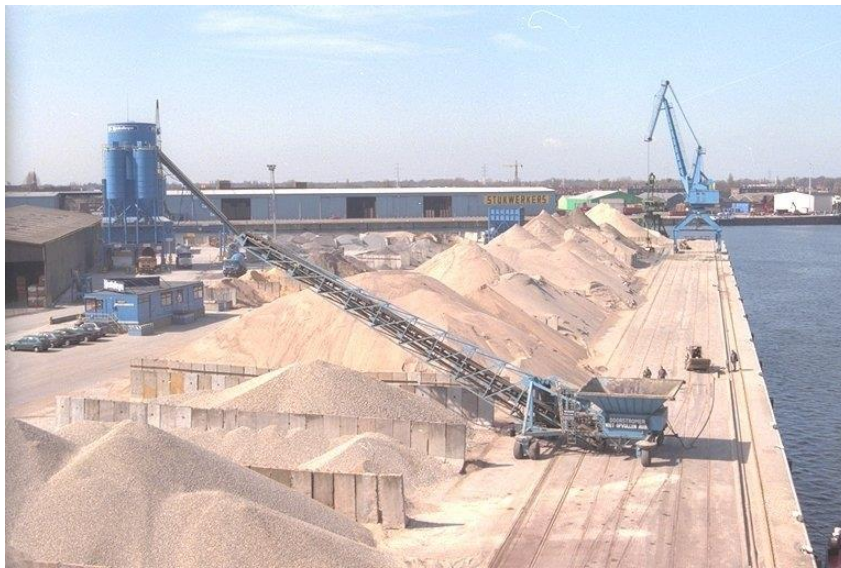
Figuur 5.2 Opslag van verschillende korrelgroepen in aparte vakken.
