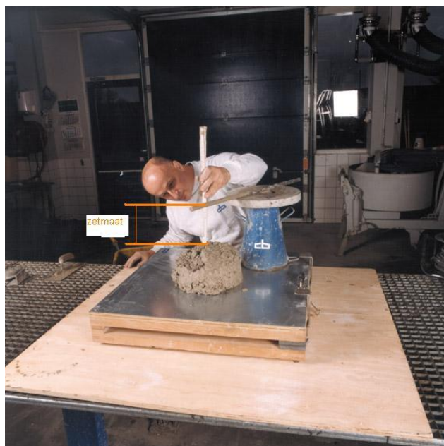
Figuur 3.3a Het meten van de zetmaat.
