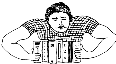
Figuur 1.5 Aanbrengen van voorspanning op een stapel boeken.
