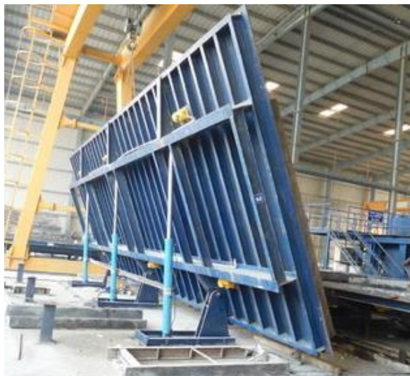
Grote triltafel met duidelijk zichtbare trilmotoren
