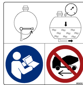
Vloeimiddelinstallatie onder druk (4.10)
