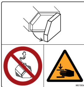
Geluidswerende deur openen
