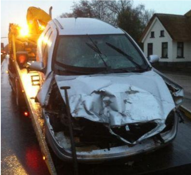
Schade aan achterop rijdende auto
